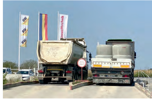
Wiegensysteme in Verbindung mit SAP bieten Kontrolle über Warenein- und Ausgang
